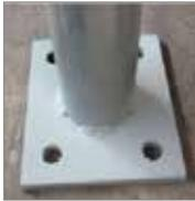
Auf Wunsch erhalten Sie den Pfosten mit angeschweißter Fußplatte (140 x 120 x 8 mm, inkl. 4 Bohrungen Ø 14 mm). Bodenverankerung muss bauseits erfolgen (Empfehlung: Injektionssystem mit Fischer-Anker FIS A/RG M12x260).
